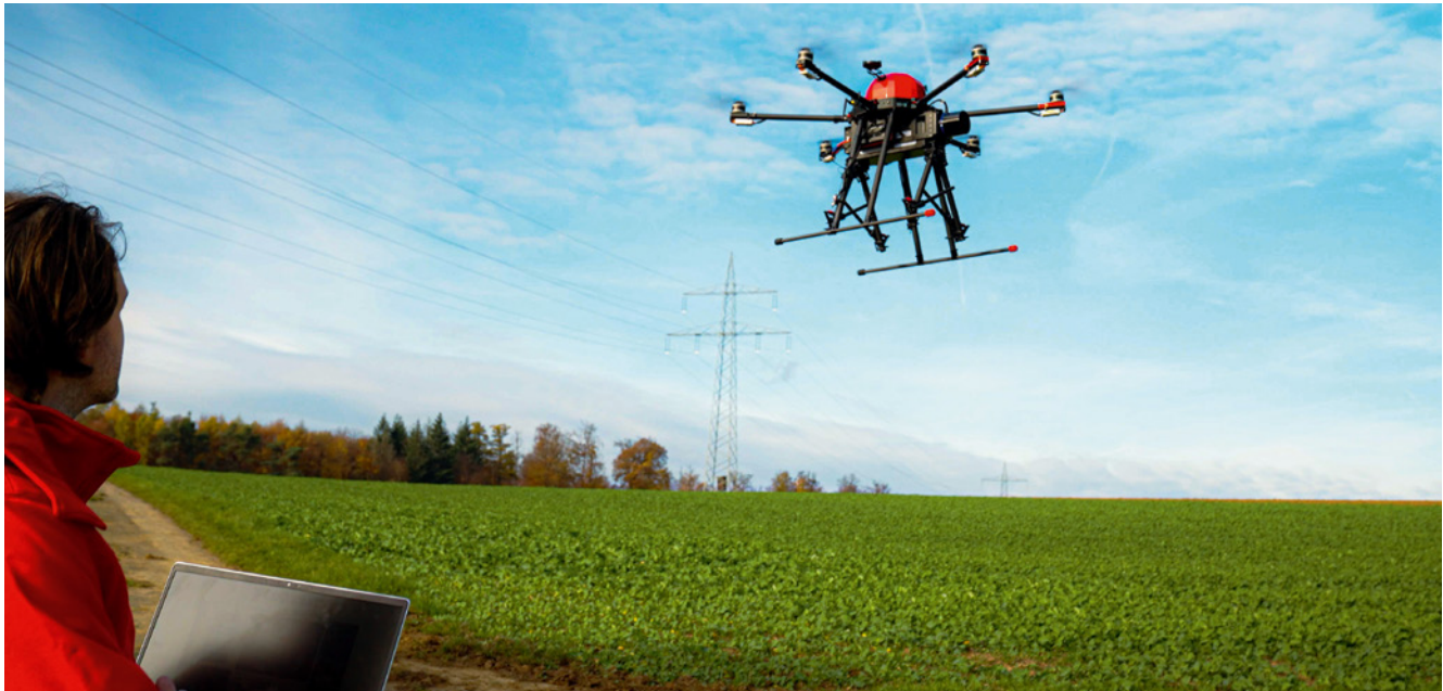
Wenn der Anflug initiiert wurde, navigiert die Drohne selbständig Richtung Freileitung
